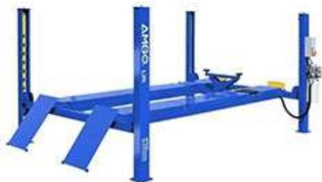
**Подъемник четырехстоечный для регулировки сход-развала AMGO A440A из европейской линии товаров фирмы PEAK CORPORATION.**
